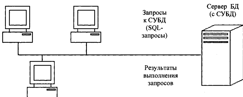
Рис. 4.2. Модель технологии клиент-сервер (двухзвенная система)
