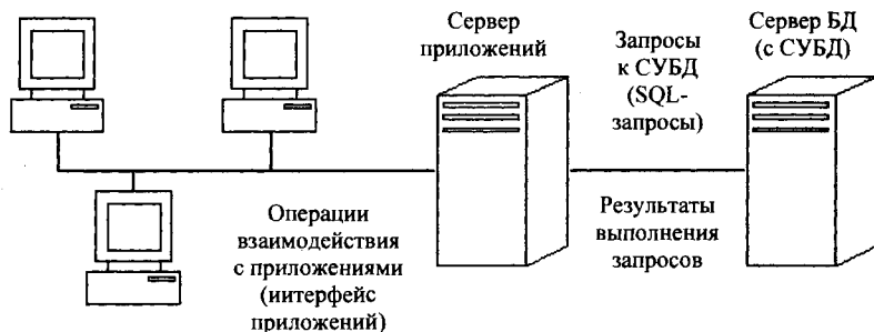
Рис. 4.3. Модель технологии клиент-сервер (трехзвенная система) с сервером приложений
