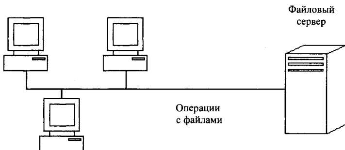
Рис. 4.1. Модель технологии файл-сервер
